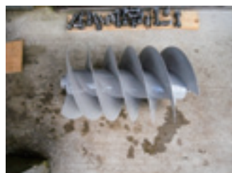
使用したスパイラー
