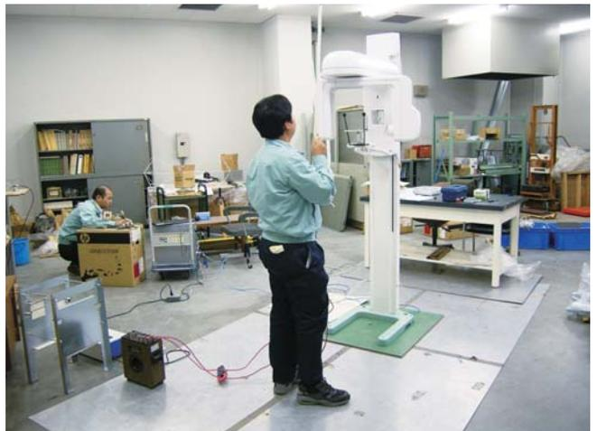
図2 電気機器への磁界印加試験の様子
