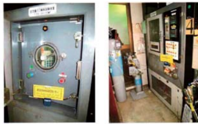
図1 環境汚染混合ガス試験装置及び処理条件 ・試験内容 3種混合耐ガス試験【H 2 S+SO 2 +NO 2 】 ・試験装置(株)山崎精機研究所 定流量フロー形ガス腐食試験装置GH-180形 ・試験条件 試験ガス・濃度 H 2 S=5ppm、NO 2 =10ppm、SO 2 =10ppm 試験温度・湿度 30.0℃・90%RH 試験日数・時間 4日間【96h】
