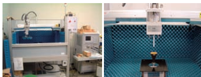
近傍界測定システム
