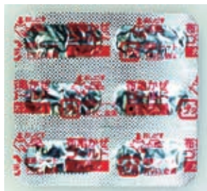
▲葉のパッケージをフラット・ドーム照明で撮像すると、穴あきが鮮明に見える 注)使用したサンプルワークは当社にて購入、加工したものであり本来の品質・性能によるものではありません。
