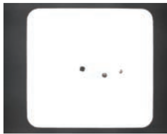
▲葉のパッケージをフラット・ドーム照明で撮像すると、穴あきが鮮明に見える 注)使用したサンプルワークは当社にて購入、加工したものであり本来の品質・性能によるものではありません。
