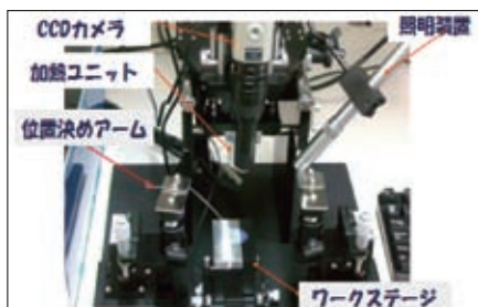
図4 実装装置本体の加工部詳細
