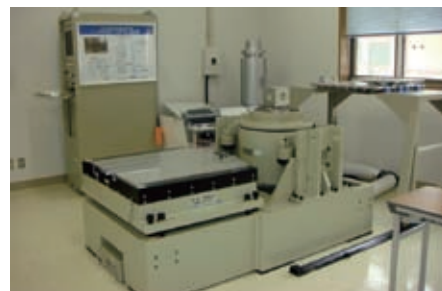
電子部品用高周波治具を取り付けて振動試験を行う状態
