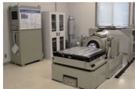
水平加振台に接続し、水平方向の振動試験を行う状態
