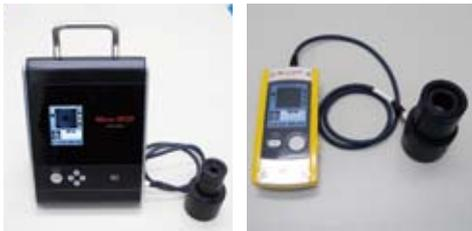
最初にデザインを検討し、その後、センサ部及びコントローラ部の詳細設計を行いました。最終的には、検出対象物に応じたセンサの品揃え、液晶カラーパネル採用による操作性向上、計測データのSDカードへの保存など、大幅な機能向上を実現しました。
