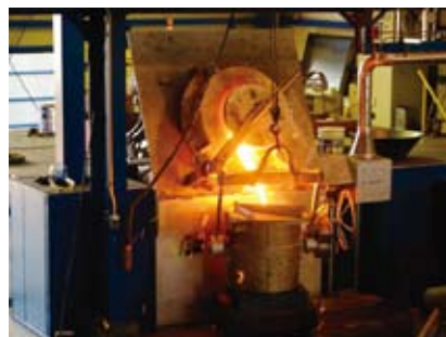
▲新たに導入した電気炉（坩堝型高周波保持炉） 鋳物の材料である鉄鉄を溶解する
