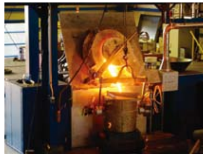
▲新たに導入した電気炉（坩堝型高周波保持炉） 鋳物の材料である鋳鉄を溶解する
