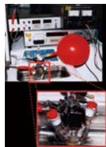
2-20mmolスケールでの電解重合用電解装置と実験用一室型電解セル
