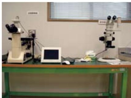
金属顕微鏡      実体顕微鏡
