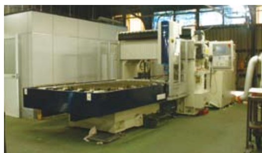
▲新しく導入された「炭酸ガス二次元レーザ加工機」
