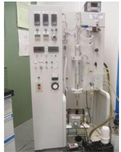
小型回転バンド式精密蒸留装置(株)三星化学研究所所有
