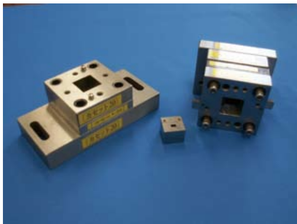
▲株式会社最上インクスが独自開発した簡易金型(一例)。 左右が保持部に「カセット」と呼ばれる。中央に写っている四角い部品が加工部で、保持部の四角い穴に装着して使用
