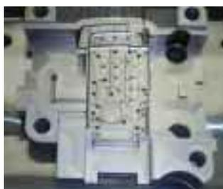
上がります。ミクロン単位の精密金型を作るため、その精度と信頼性は厳しく要求されます。このような状況に対応するため、より高精度でしかも短期間製造が可能な光造形、いわゆる『金属光造形複合加工』技術の基礎を松下電工株式会社が開発されました。
