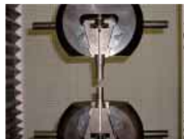
(写真1) 金属丸棒の引張試験 (機器貸付:1,900円/時間)
