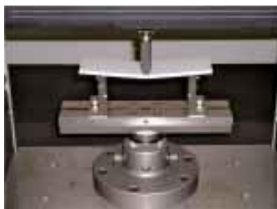
(写真2) プラスチック平板の3点曲げ試験 (機器貸付:1,500円/時間)
