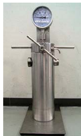
凍結昇圧装置
