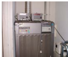
電源高調波電流測定システム
