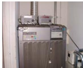
電源高調波電流測定システム
