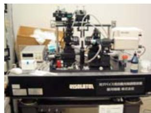
光デバイス用自動光軸調整装置
