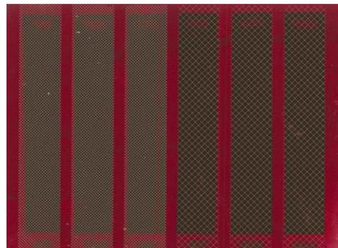
Agグリッド-ITO複合電極を用いて作製した有機薄膜太陽電池
