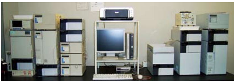
当センターの高速液体クロマトグラフシステム
